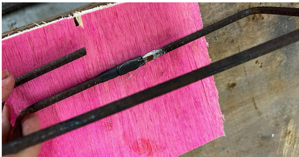
Figura 3.7 - Extensômetros elétricos de resistência na armadura transversal
