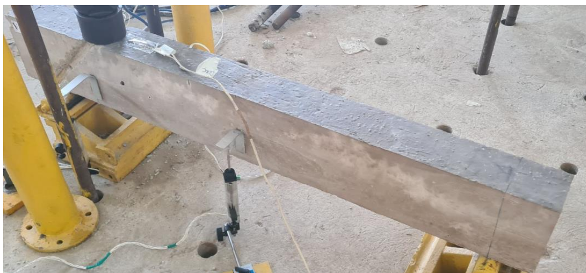
Figura 3.8 - Extensômetro elétrico de resistência no concreto
