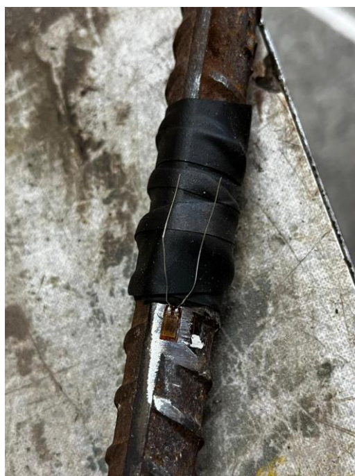
Figura 3.6 – Extensômetros elétricos de resistência na armadura longitudinal
